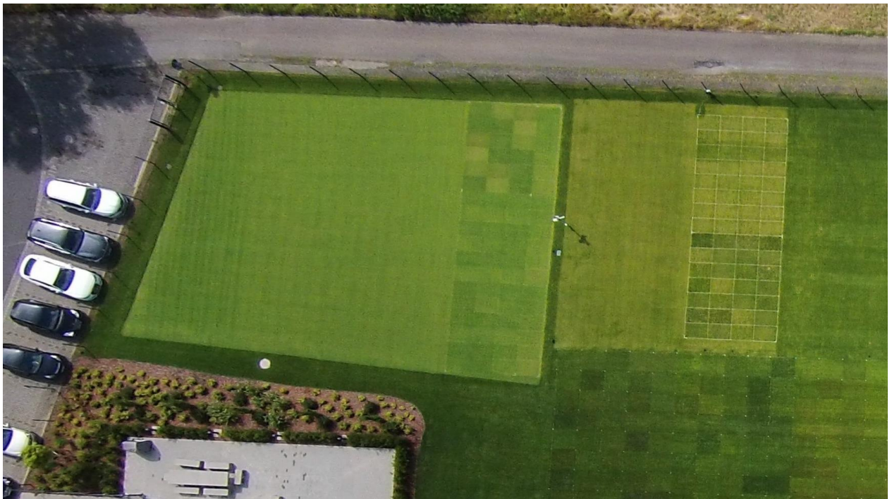
Green (Aufbau nach FLL K3) für Versuche mit flüssigen und granulierten Düngern
