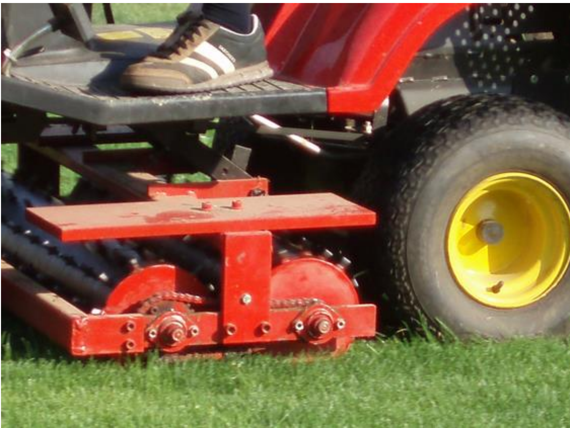
Einsatz der Stollenwalze zur Simulation der Scher- und Druckbelastung im Fußballrasen
