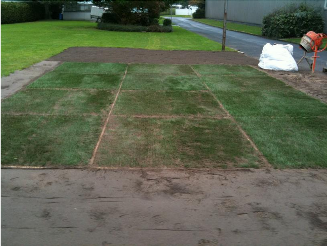
Hybridrasen für Fußball: Versuchsfläche mit unterschiedlichen Systemvarianten wie Bodenaufbau und Belastungsintensität
